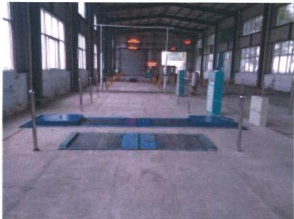
根据《机动车安全技术检验项目和方法》(GB21861-2014)的要求，自2017年3月1日起，各检测机构对重中型货车、专项作业车、挂车及大中型客车进行安全技术检测时应使用车辆外廓尺寸自动测量装置及具备加载功能的制动检测台进行测量。
